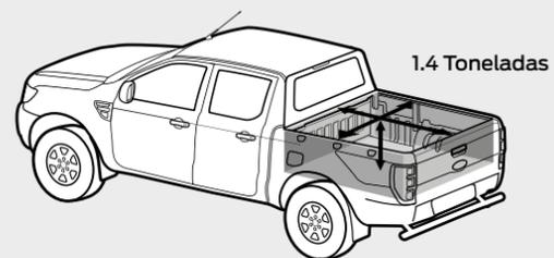
a) Despeje mínimo del suelo de 23.7 cm b) Ángulo de ataque de 22 grados c) Ángulo de salida de 20 grados
