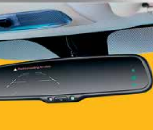
CÁMARA DE REVERSA. En Reversa, se muestra en el espejo retrovisor una imagen de lo que hay detrás del vehículo.
