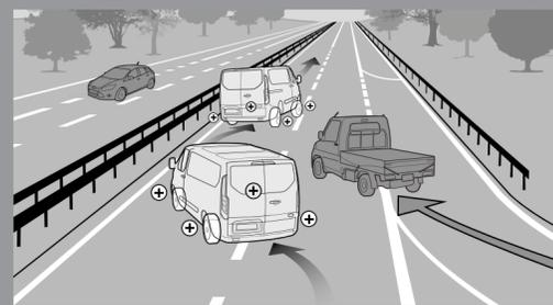
Transit Custom está equipada con el Sistema de Control de Tracción, que está diseñado para prevenir la pérdida de adherencia en las ruedas al momento de un derrape, disminuyendo su velocidad de giro automáticamente y moderando la potencia del motor.
