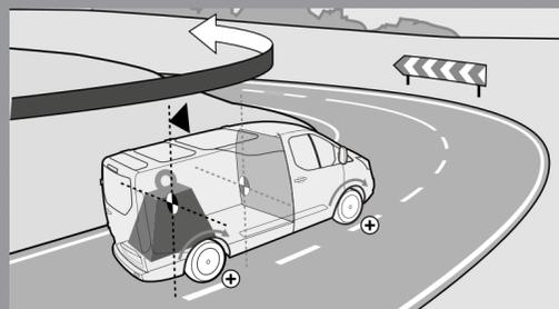
La Distribución Electrónica de Frenado (EBD) repartirá la fuerza entre los frenos traseros según la condición de carga lo requiera. Logrando frenar lo mejor posible antes de activar el sistema ABS.
