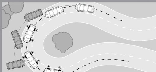
El Control Electrónico de Estabilidad es un dispositivo que ayuda a evitar accidentes actuando en el frenado individual de las ruedas para lograr que no se pierda el control de la unidad, cuando alguna de las llantas pierda la estabilidad.
