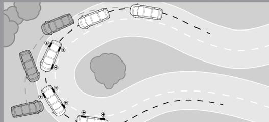
Este programa corregirá automáticamente tu posición en la carretera, dependiendo de la cantidad de carga que contenga tu Transit en alguna situación de derrape con ayuda del Control Adaptativo de Carga (LAC), garantizando su estabilidad en todas las condiciones de manejo.
