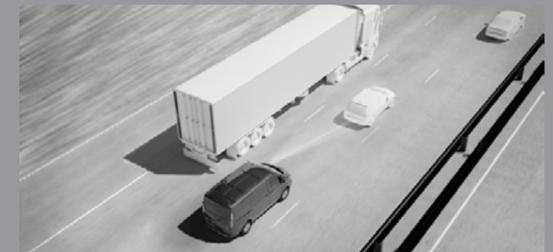
Esta asistencia identifica cuando el pedal de freno se presiona de manera repentina por una situación de urgencia y brinda la máxima fuerza de frenado, aun cuando el pedal no haya sido presionado a fondo.
