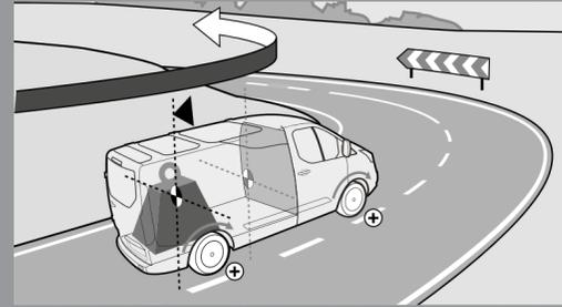
Con este sistema, tu Transit Custom calculará el peso y la distribución de su carga, ajustando su sistema integral de seguridad que incluye el ESP, ABS y Control de Tracción (TC), para brindar la estabilidad que requiere y maximizar su eficiencia.
