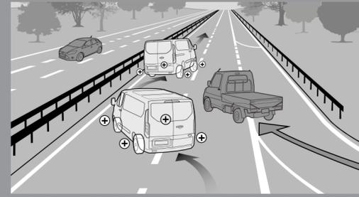
Transit Custom está equipada con el sistema de Control de Tracción (TC), que está diseñado para prevenir la pérdida de adherencia en las ruedas al momento de un derrape, disminuyendo su velocidad de giro automáticamente y moderando la potencia del motor.
