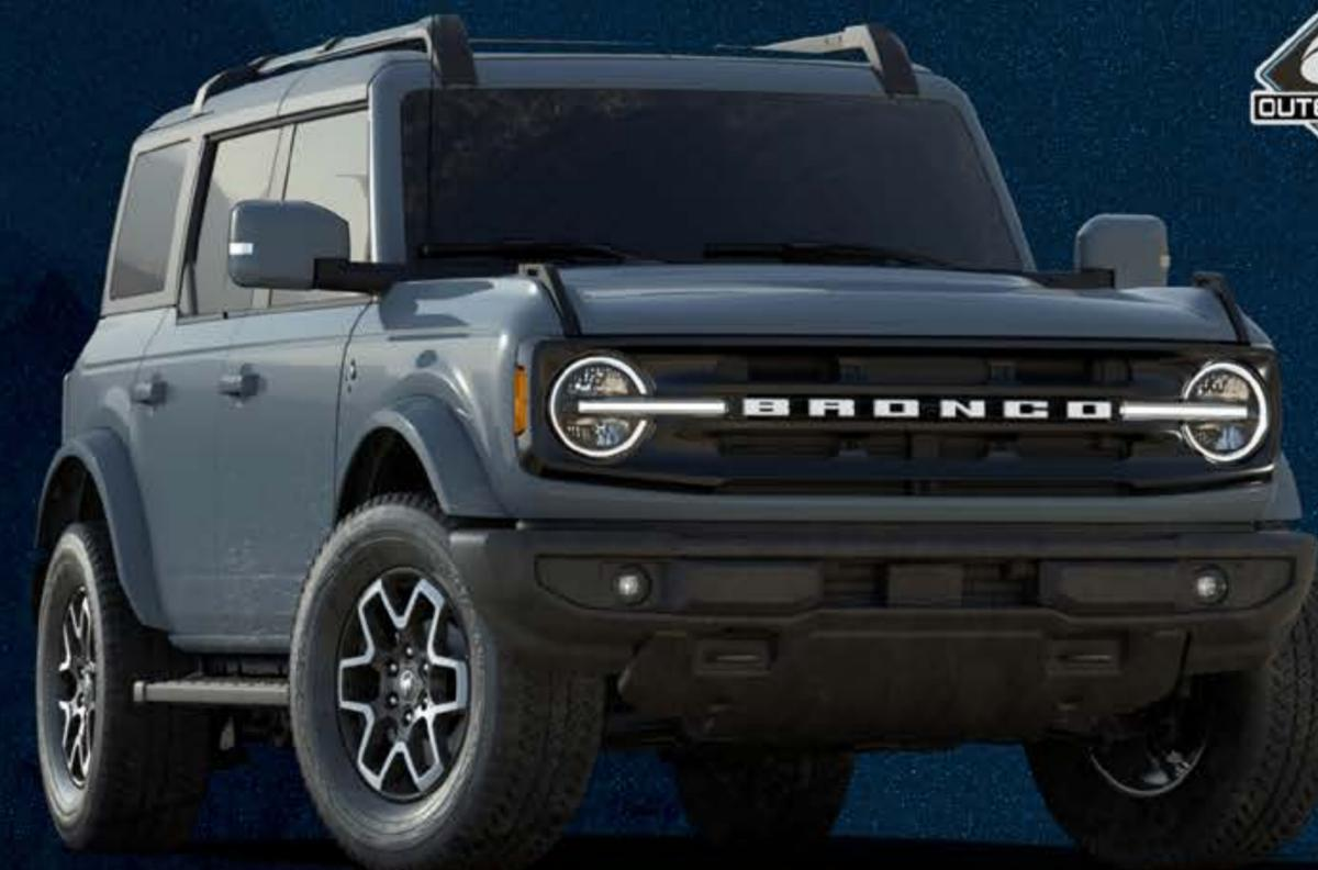
Espejos Laterales Montados en Carrocería para Visibilidad Durante Conducción sin Puertas
